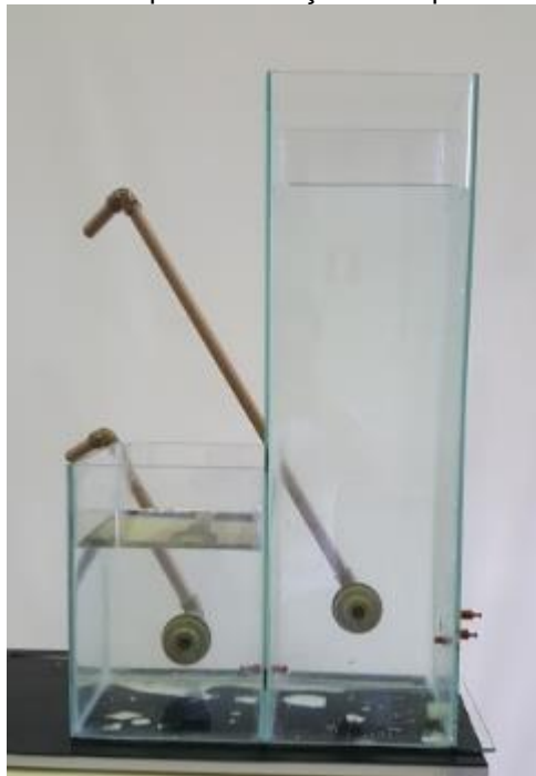
Figura 13 - Aparato desenvolvido para realização de experimentos em orifícios e bocais
